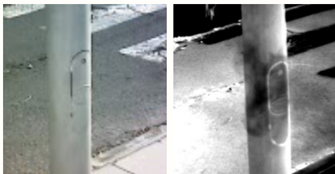
Detección de gas en zonas de La Palma a través de una cámara OGI. Fuente: Apliter Termografía.
