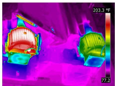
Con la termografía, puede saber rápidamente que el motor de la izquierda se está calentando y saber que debe realizar una inspección más exhaustiva.
