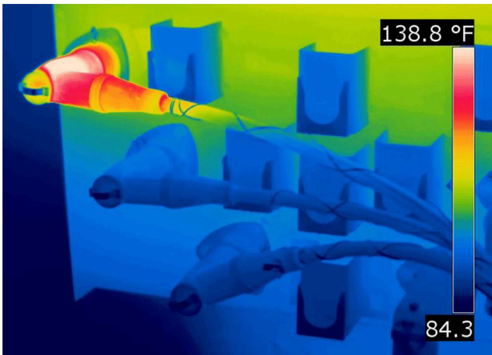
Las conexiones eléctricas deficientes pueden identificarse fácilmente antes de que causen paradas de producción.
