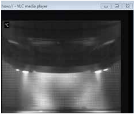
Imágenes térmicas de la vista del extremo trasero. Visible a la izquierda: los registros de escape abiertos a un número superior de rpm.
