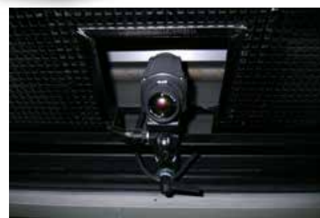
Una solución central: TOPA instaló una cámara A310 de FLIR con lentes de gran angular de 45° en cada uno de los 10 dinamómetros.
