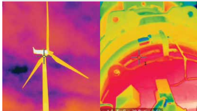
La termografía se puede utilizar para detectar problemas eléctricos y mecánicos.
