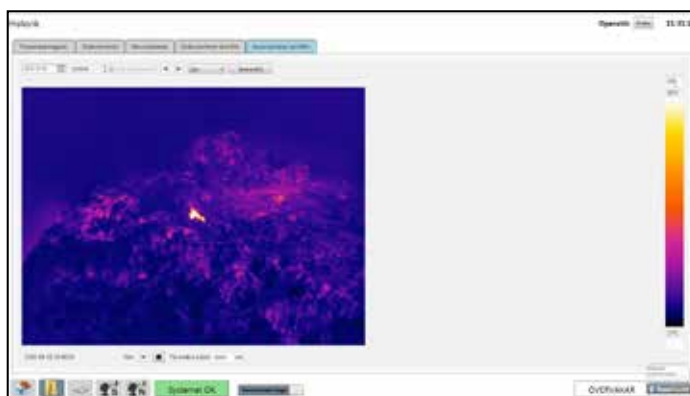
Claes Nelsson, Termisk Systemteknik: "TST Fire realiza un análisis preciso en tiempo real de la imagen de vídeo térmica de FLIR. Si se detectan temperaturas inusualmente altas, se activa una alarma."
