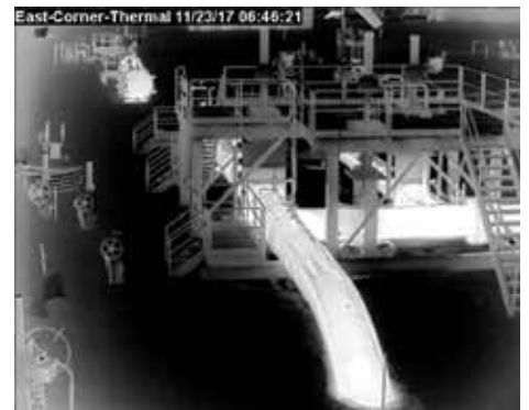
El análisis de vídeo de DCAM tiene en cuenta el movimiento del líquido y el tamaño de la fuga.
