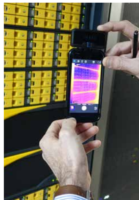
Las comprobaciones puntuales en bastidores ayudan a resaltar la recirculación de aire caliente. Aquí vemos que el equipamiento está bien y frío alrededor de las tomas de aire.
