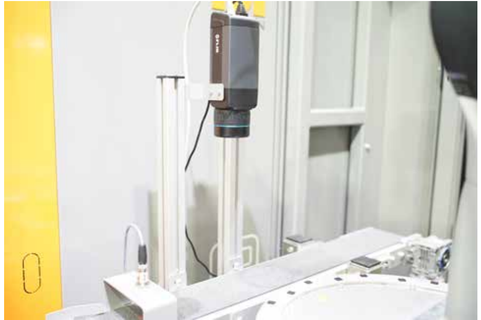
La cámara fija FLIR A615 cumple con gran variedad de estándares, lo que la convierte en un dispositivo «plug-and-play» para software de visión artificial de otras marcas.
